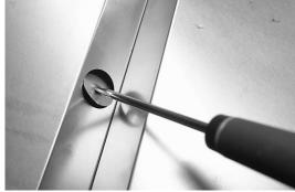
Mit einem flachen Schraubendreher kann die Öffnung freigelegt werden.
